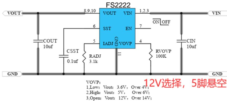
在我们 9V 输入应用中，要选择 12V 模式才能满足，由于每个输出电压模式，对应的输入电压范围也是不同的。例如 12V 模式的话，输入电压范围是 8.8V-14V 之间，超过输入电压就会关闭输出。同时最大可调限流值 4.5A.范围是 1A-4.8A 之间。
